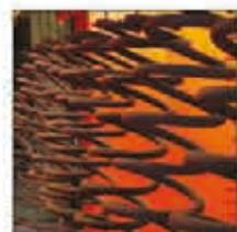
При производстве пружин K-flex компании KYB используется технология холодной и горячей катки. Тщательно контролируемый процесс дробеструйной обработки значительно продлевает срок службы пружины. Все пружины K-flex сначала обрабатываются в растворе фосфорной кислоты, а затем покрываются эпоксидным порошком. Такая процедура гарантирует плотное долговечное покрытие с антикоррозийными свойствами.
